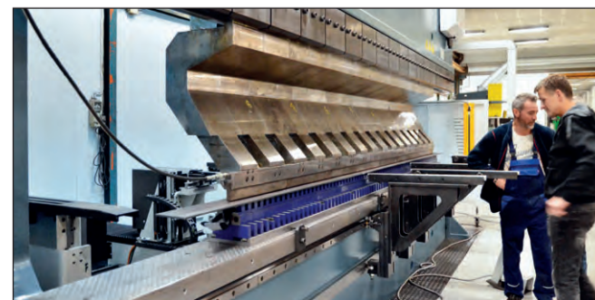
Kantpressen kan trykke 600 tons og er udstyret med en åbning på 1.150 millimeter.
